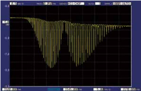
氨化氢 \text{H}_3\text{C}_{14}\text{N} 的吸收光谱测量(AQ6375B)
